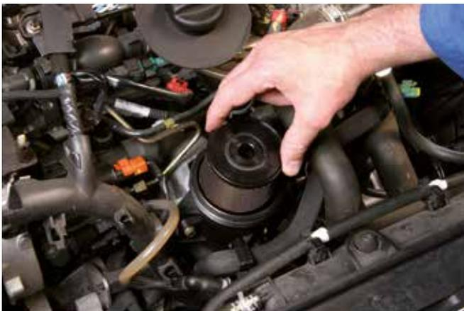
ж) Определите расположение уплотнительных колец.
