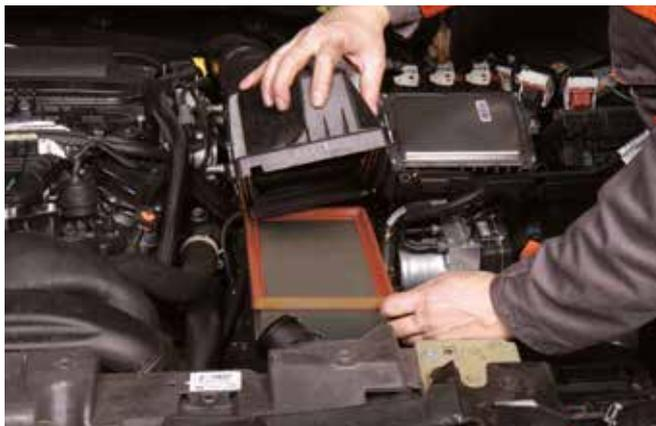
ж) Очистите корпус воздушного фильтра и его крышку (используйте влажную ткань). Пока не закрыта крышка корпуса убедитесь, что внутрь не попало никаких посторонних предметов, иначе они могут попасть в двигатель и вызвать тем самым серьезные последствия.
