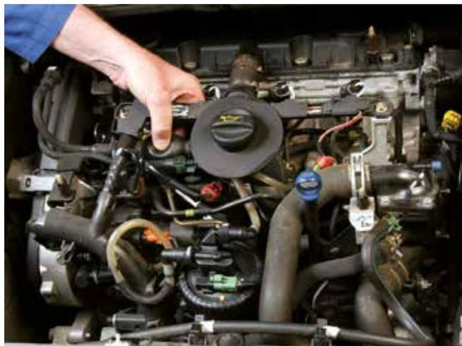
н) Проверьте топливную систему на наличие утечек.
