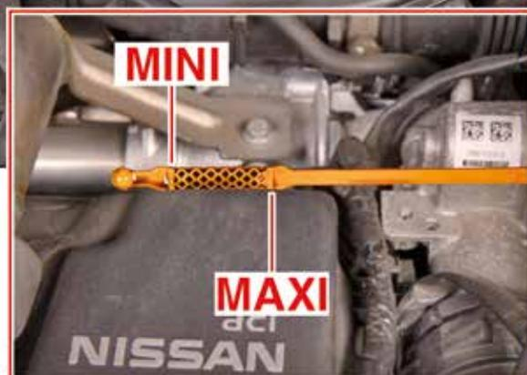
п) Проверьте уровень масла с помощью щупа; протрите его чистой тканью, чтобы определить точный уровень масла.
